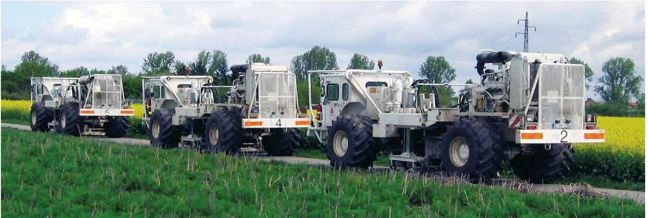
**Abb. 6:** Seismische Messung: Erzeugung von Erschütterungen mittels Vibroseismik.
