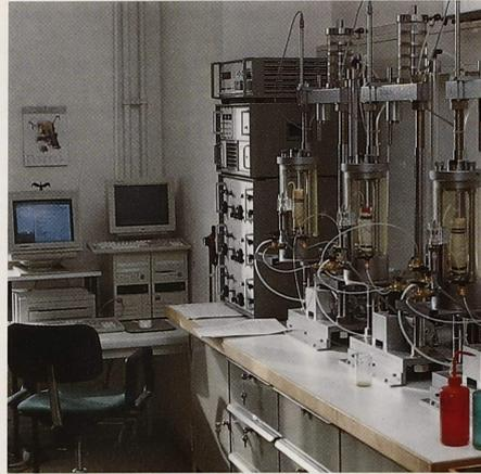
Abb. 39. Vollautomatisches Triaxialgerät zur Bestimmung der Scherfestigkeit von Lockergesteinen.
