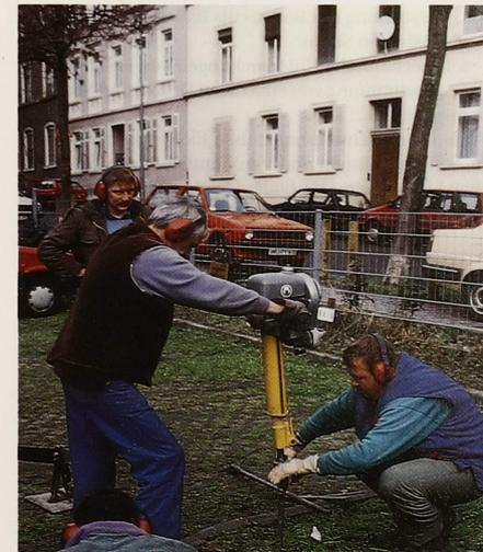
Abb. 36. Erkundung oberflächennaher Sedimente mittels Sondierbohrungen.
