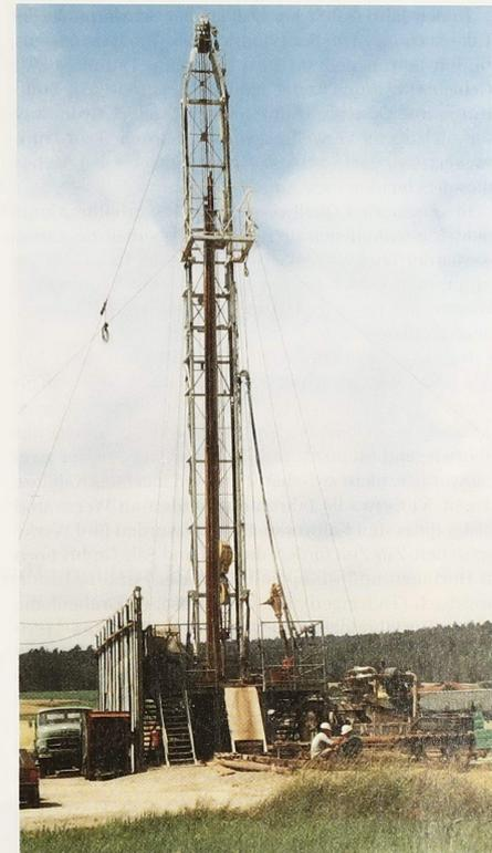
Abb. 22. Untersuchungsbohrung auf tiefe Grundwasser bei Neuhof/Fulda, Ortsteil Tiefengruben.
