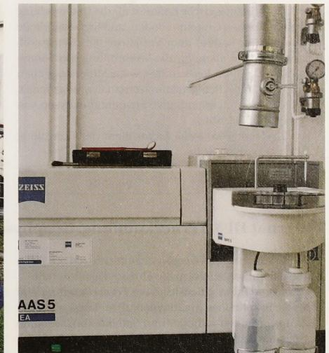
Abb. 37. Bestimmung chemischer Elemente mit der Atomabsorptionsspektrophotometrie.
