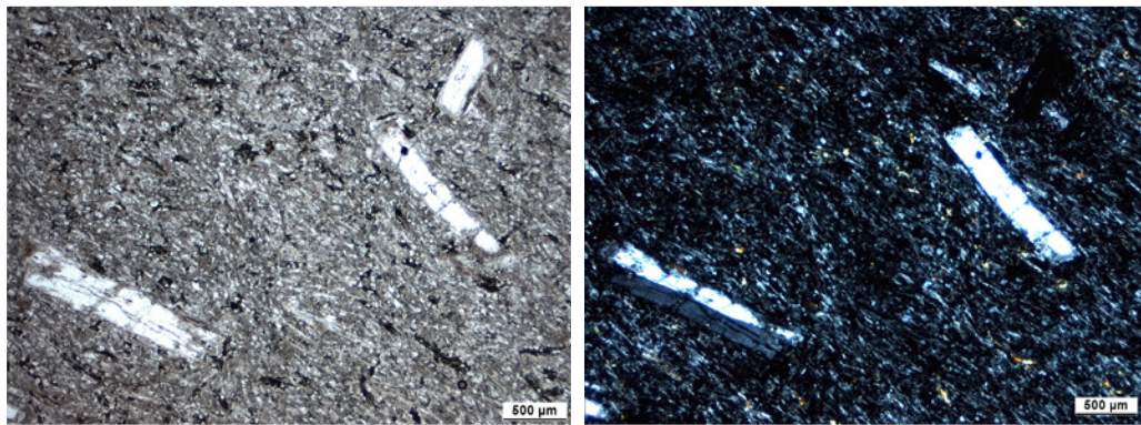
Dünnschliffaufnahmen des Phonoliths: Zum Teil zerbrochene Alkalifeldspat-Einsprenglinge in einer weniger ausgeprägt trachytischen Grundmasse aus Alkalifeldspäten mit Erzkomponente [54].
