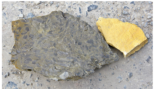
Handstücke mit von Wurmspuren durchsetztem Kalkstein (links) bzw. Gelbkalk (rechts) aus der Oberen Oolithbank im Unteren Wellenkalk (m1) [8].
