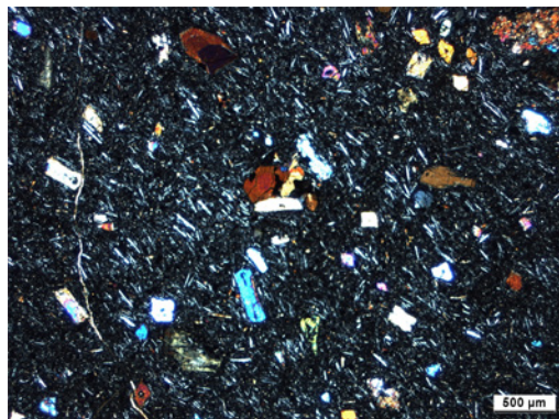
Dünnschliffaufnahmen des Trachybasalts: Einsprenglinge von Olivin, z. T. schon iddingsitisiert, und Klinopyroxen in feiner, leicht fließgeregelter Grundmasse aus Plagioklasleisten, Klinopyroxen und Erzmineralen.
