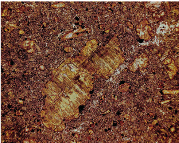
Dünnschliffaufnahme des Basanits ohne gekreuzte Polarisatoren. Die Olivin-Einsprenglinge sind teilweise iddingsitiert. Bildbreite 2,8 mm.
