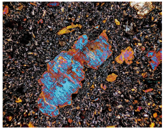
Dünnschliffaufnahme des Basanits (wie links) mit gekreuzten Polarisatoren. Die Minerale mit den leuchtend blauen Interferenzfarben sind Olivine. Bildbreite 2,8 mm.
