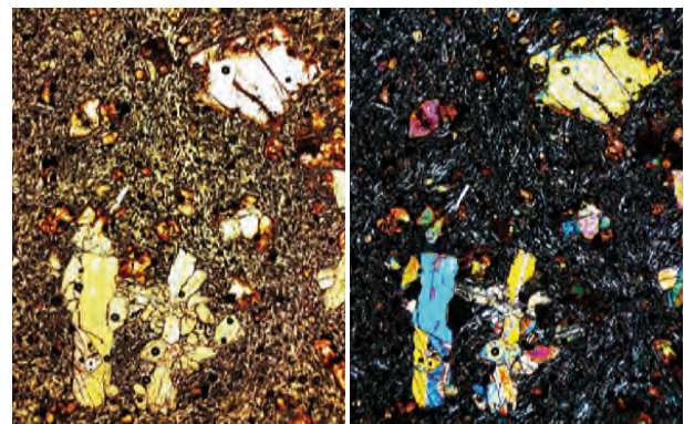
Dünnschliffaufnahmen des Alkalibasalts. Bildhöhe 2,8 mm. Links: Das porphyrische Gestein enthält Olivin- und Klinopyroxen-Einsprenglinge (ohne gekreuzte Polarisatoren). Rechts: Die Plagioklase bilden keine Einsprenglinge, sondern kommen nur als Nadelchen in der Matrix vor (mit gekreuzten Polarisatoren).
