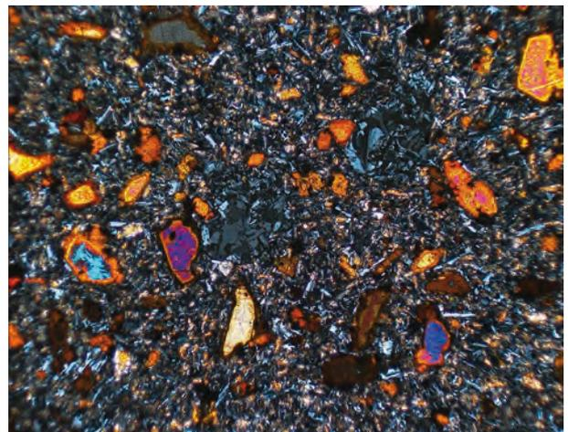
Dünnschliffaufnahme des Basalts (wie links) mit gekreuzten Polarisatoren. Die Blasen sind mit Zeolithen gefüllt. Bildbreite 2,8 mm.
