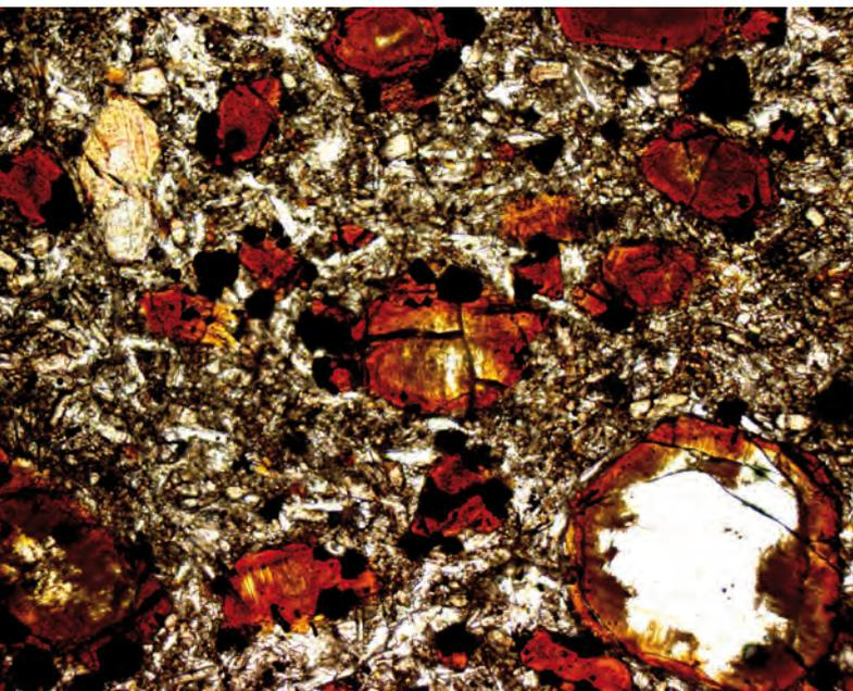
Dünnschliffaufnahme des Basanits ohne gekreuzte Polarisatoren. Die Olivin-Einsprenglinge sind weitgehend iddingsitisiert.
