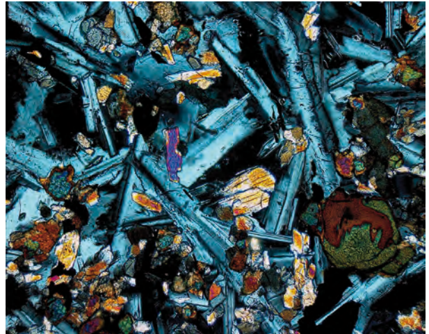
Dünnschliffaufnahme des mittelkörnigen Basalts (wie links) mit gekreuzten Polarisatoren. Bildbreite 2,8 mm.
