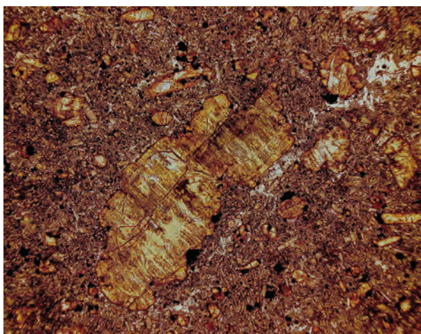
Dünnschliffaufnahme des Basanits ohne gekreuzte Polarisatoren. Die Olivin-Einsprenglinge sind teilweise iddingsitisiert. Bildbreite 2,8 mm.
