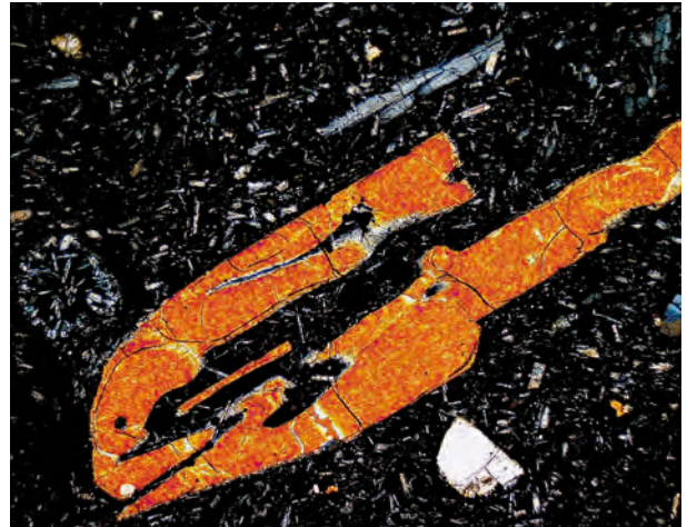
Dünnschliffaufnahme des Basanits (wie links) mit gekreuzten Polarisatoren. Die bläulichen, stengeligen Minerale oberhalb des Olivins sind Klinopyroxene. Links über dem Olivin eine Mandel. Bildbreite 2,8 mm.
