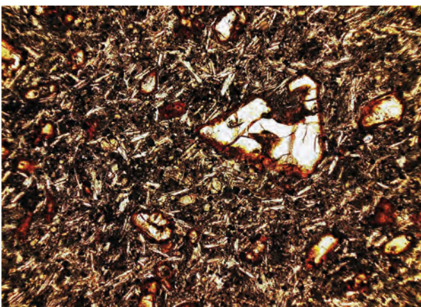
Dünnschliffaufnahme des Alkalibasalts ohne gekreuzte Polarisatoren. Die hellen Einsprenglinge sind Olivine, zum Teil randlich iddingsitisiert. Die Grundmasse enthält Plagioklas, bräunlichen Klinopyroxen und Erz. Bildbreite 2,8 mm.
