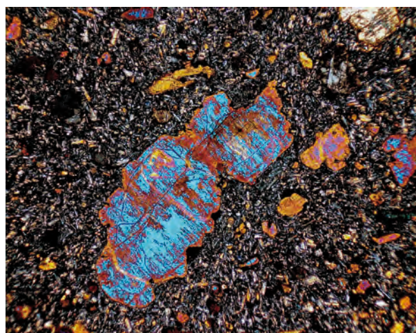
Dünnschliffaufnahme des Basanits (wie links) mit gekreuzten Polarisatoren. Die Minerale mit den leuchtend blauen Interferenzfarben sind Olivine. Bildbreite 2,8 mm.
