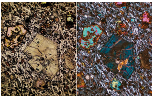
Dünnschliffaufnahme des Basalts der Burg. Bildhöhe 2,8 mm.
