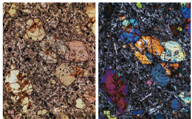
Dünnschliffaufnahme des Basalts. Bildhöhe 2,8 mm.
