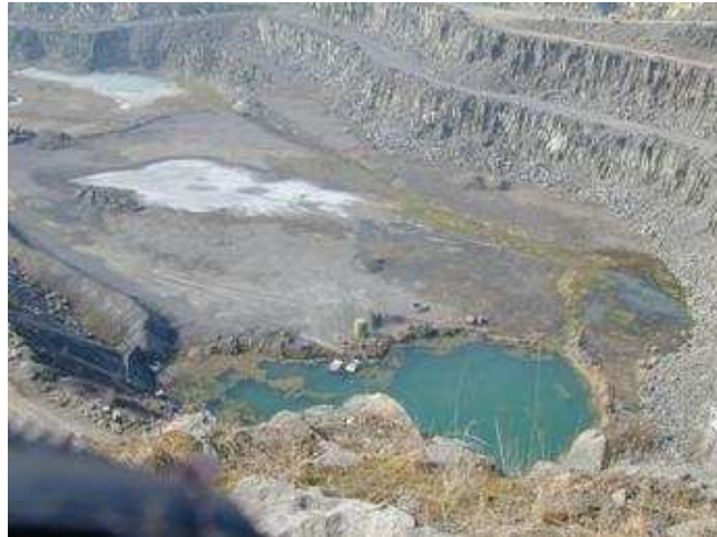
Abb. 33: Wasserhaltung auf der tiefsten Sohle im Tagebau Unter-Widdersheim (Foto: N. Hug/HLUG, 2003)
