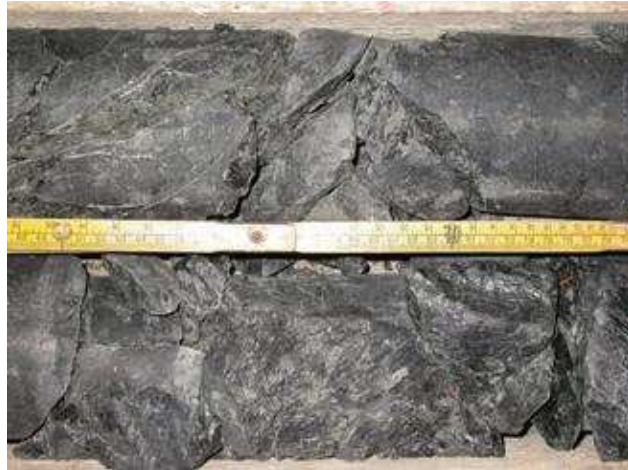
Abb. 42: Bohrkern aus zerschertem Metadolerit, der in cm-kleine sigmoidale Scherkörper zerlegt ist; die Außenflächen der Scherkörper sind mit dunkelgrünem Chlorit und Serpentin belegt und daher glänzend, sehr glatt und wachsartig-seifig. Oben rechts liegt zerschertes Gestein im noch intakten Gesteinsverband; es zerspringt bei geringer Schlagbeanspruchung in die Scherkörper (Foto: N. Hug/HLUG)
