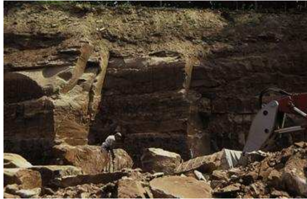
Abb. 55: Abbau von Naturwerkstein aus dem Unterem Buntsandstein im Odenwald bei Grasellenbach.
