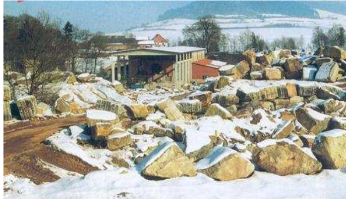
Abb. 58 Naturwerkstein-Rohlinge in einem Quarzsandstein-Tagebau bei Friedewald. Friedewalder Sandstein (Mittlere Buntsandstein, Solling-Folge)
