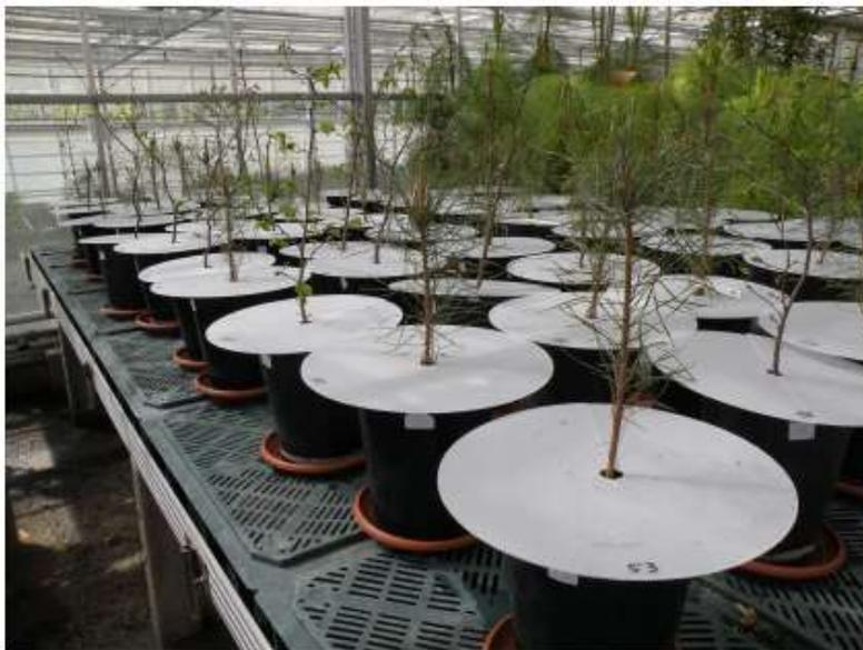
Abbildung 9: Topfversuch im Gewächshaus. Randomisiert aufgestellte Pflanztöpfe mit Verdunstungsschutz und Sickerwasserauffangschalen.
