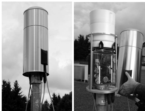
Abb. 5: PLUVIO-OTT-Niederschlagsmesser, rechts mit abgenommenem Schutzzyylinder, so dass der weiße Auffangbehälter und die darunterliegende Elektronik sichtbar ist (DWD 2015).
