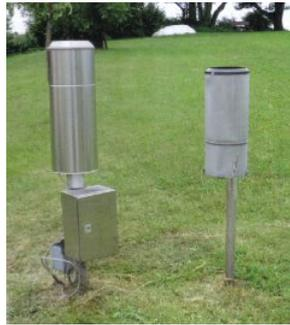
Abbildung 2.1.: *Geräte zur Niederschlagsmessung: Automatisierter, digitaler Niederschlagsmesser (Ombrometer) (links) und Niederschlagsmesser nach Hellmann (rechts).*
