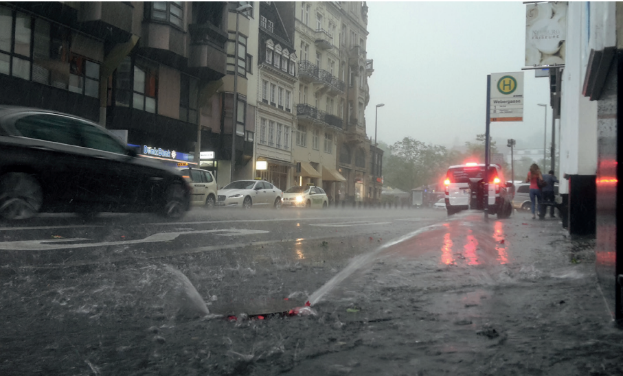
Kanalnetzüberlastung nach Starkregen in Wiesbaden (27. Mai 2016).
