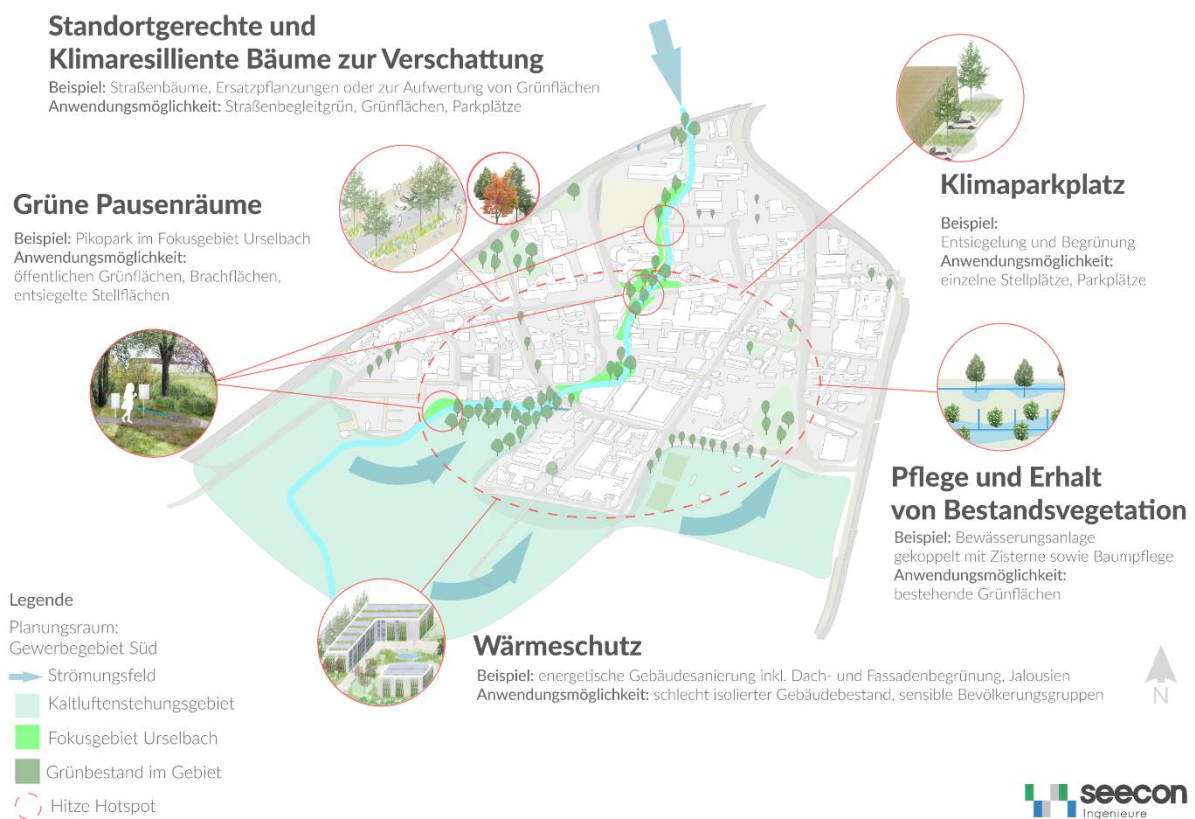
Abbildung 26: Maßnahmenkarte zur Hitzevorsorge im Gewerbegebiet Süd: Die Abbildung zeigt die priorisierten Klimaanpassungsmaßnahmen zur Reduzierung der Hitzebelastung. Verortet werden insbesondere Maßnahmen in der identifizierten Hitze-Hotspots. Darunter sind u.a. Begrünungs-, Verschattungs- und Entsiegelungsmaßnahmen zur Verbesserung des lokalen Mikroklimas.
