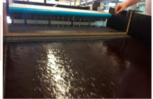
Kipprinne im Betrieb, mit glatter Oberfläche. Eine definierte Wassermenge wird auf die Kipprinne aufgebracht. © E. Ruiz Rodriguez
