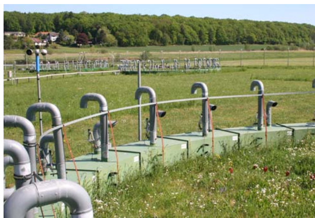
Gießener Freiland-CO 2 -Anreicherungssystem (GiFACE), Ringe mit 8 m Innendurchmesser
