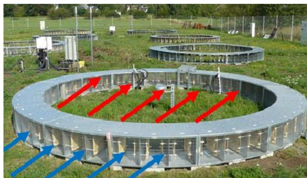
Giessen T-FACE mit +2 °C Lufttemperatur und +20 %  $\text{CO}_2$ , Innendurchmesser: 4,3 m (Start 2018). Pfeile = Luftströmung bei Wind, blau = Umgebungstemperatur, rot = +2 °C
