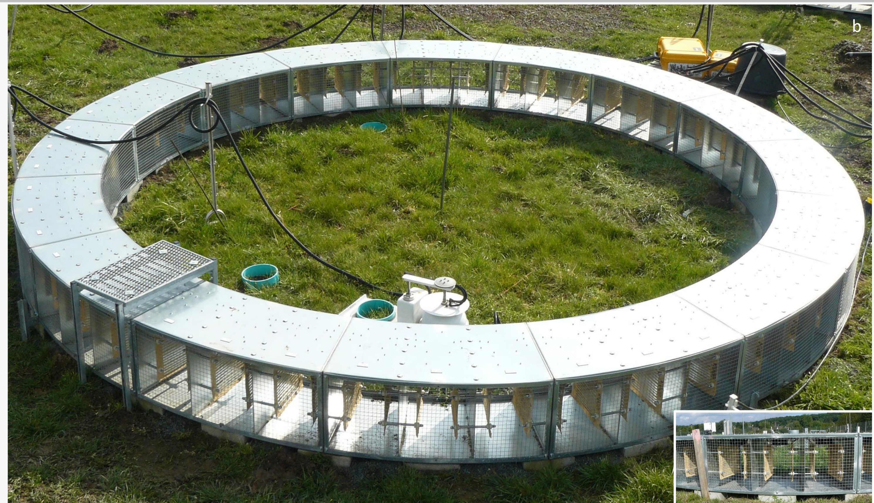
Abbildung 1: Funktionsprinzip und Instrumentierung (a) sowie ein aufgebauter Thermo-FACE-Ring (b). Abhängig von der Windrichtung und -geschwindigkeit werden in den windseitigen Segmenten die Heizelemente und CO 2 -Düsen so gesteuert, dass tagsüber in der zentralen Ringfläche eine Lufttemperaturerhöhung um 2°C und eine CO 2 -Anreicherung um 20% im Vergleich zu den Kontrollringen erreicht wird. In den Ringen sind Subplots für vegetationskundliche und bodenkundliche Arbeiten definiert und mit Sensoren bestückt. → s. F2F-Video
