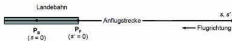
Abbildung 2: Streckenkoordinatensysteme  $s$  und  $s'$
