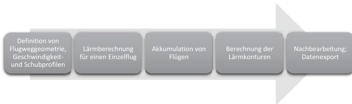
Abbildung 1: Der Prozess der Lärmkonturengenerierung
