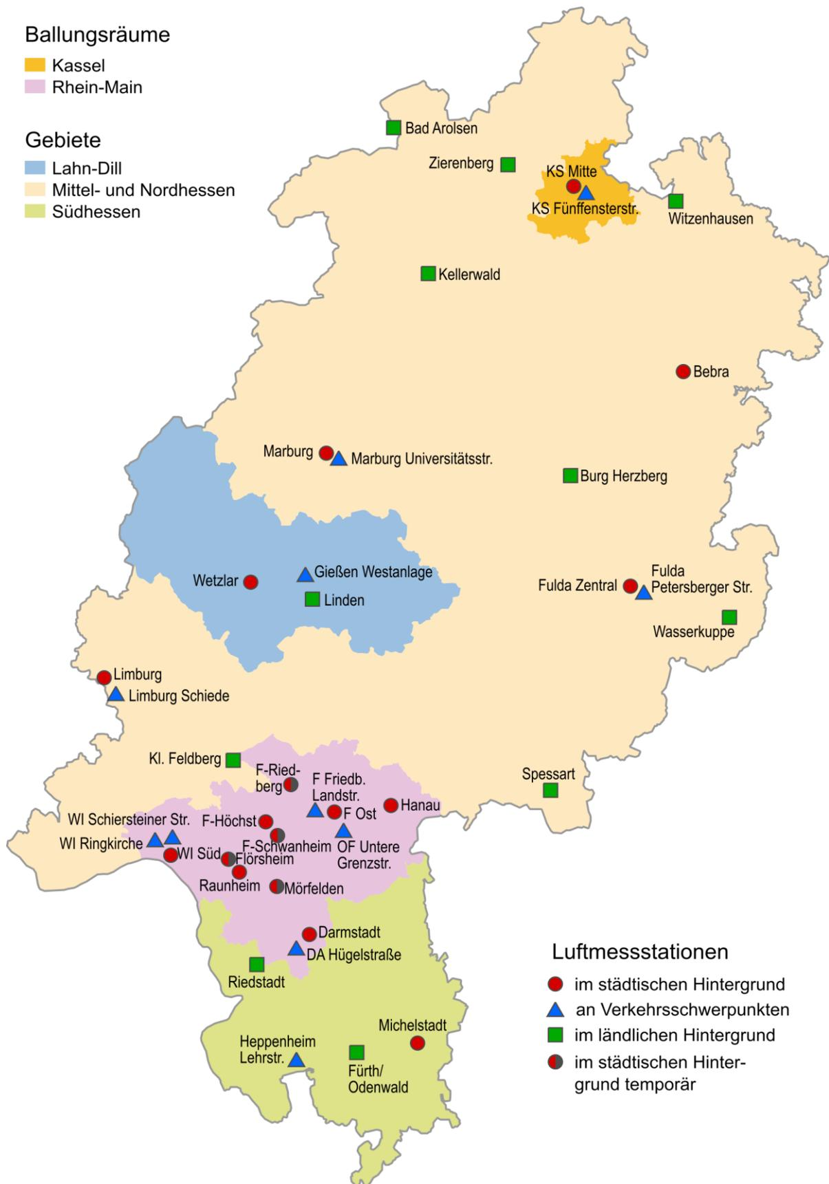
**Abb. 1:** Hessisches Messnetz zur kontinuierlichen Überwachung der Luftqualität (Stand 2021)
