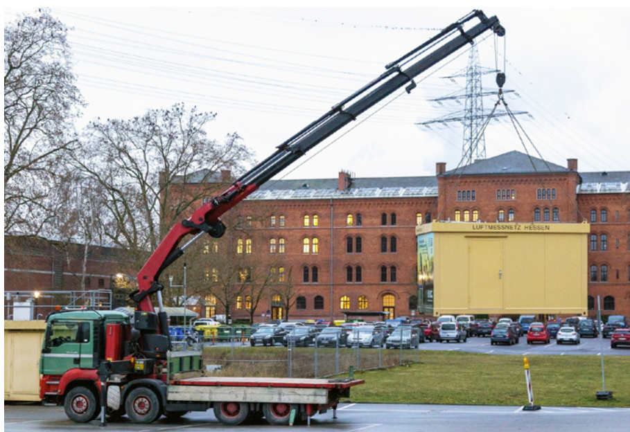
Abb. 19: Der neue Stationscontainer wird beim HLNUG auf den Kranwagen aufgeladen © HLNUG
