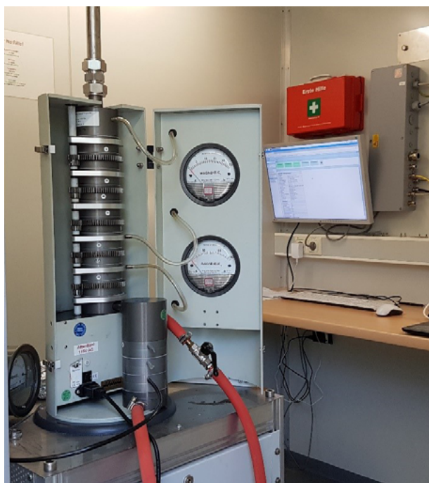
Abb. 18: Kaskadenimpaktor zur Sammlung von ultrafeinen Partikeln in der Luftmessstation Frankfurt-Schwanheim © Alexander Vogel
