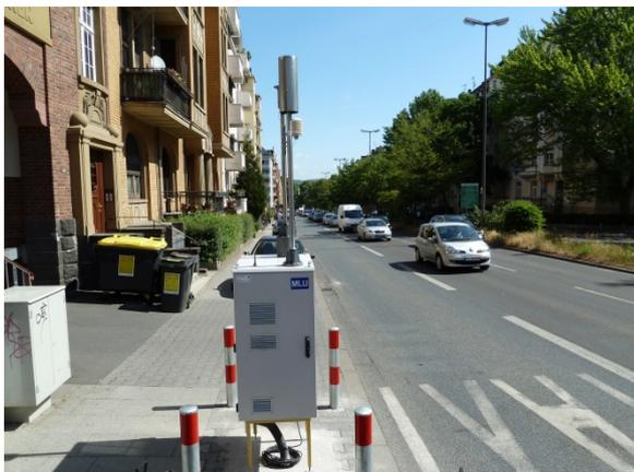
Abb. 6: Verkehrsbezogene Luftmessstation Wiesbaden-Schiersteiner Straße
