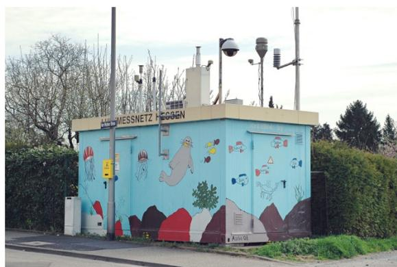
Abb. 5: Luftmessstation des städtischen Hintergrundes Wiesbaden-Süd
