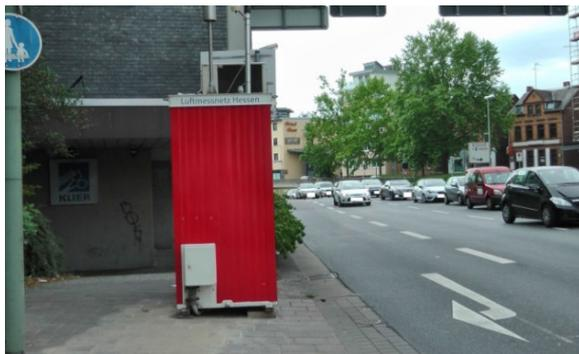
Abb. 4: Verkehrsbezogene Luftmessstation Limburg-Schiede; Foto: HLNUG
