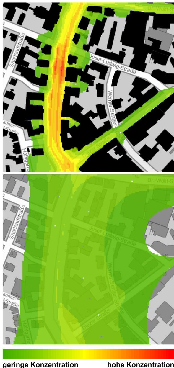
Abb. 10: Schematische Darstellung der durch den lokalen Fahrzeugverkehr verursachten räumlichen Belastung von NO<sub>2</sub>; MISKAM-Berechnung [vgl. 4.2.4] mit Bebauung (obere Abbildung) und ohne Bebauung (untere Abbildung); Kartengrundlage: © GeoBasis-DE / BKG 2021
