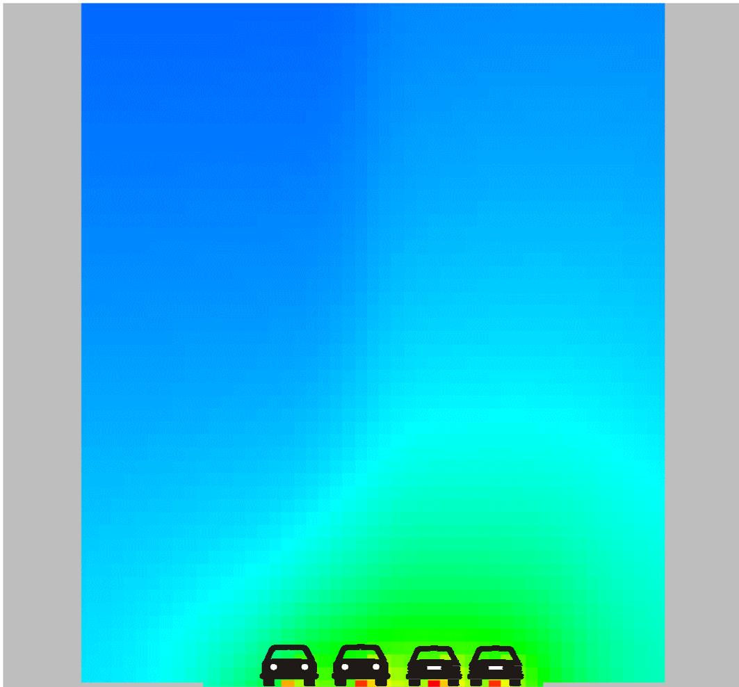
Verteilung der Konzentrationstagesmittelwerte in einem Straßenraum (Bebauungsabstand 24m, Bebauungshöhe 28 m) mit Windrichtung zwischen 107° und 170° und Windgeschwindigkeit zwischen 1.7 m/s und 3.8 m/s
