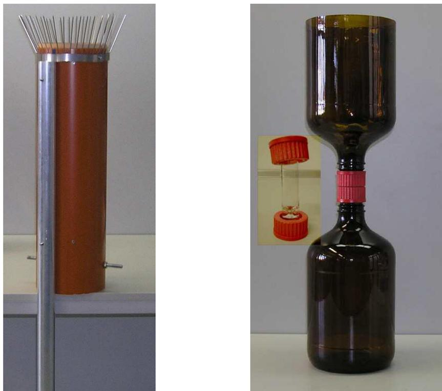
**Abbildung 3.1:** Trichter-Flasche-Sammler und Probennahmesystem
