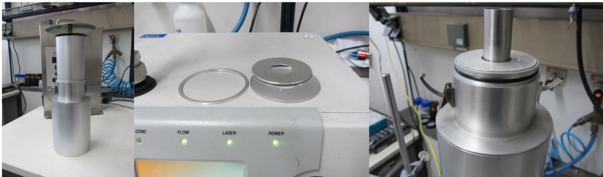
**Abbildung 2:** Links: Zusammengesetzter Impaktor, Mitte: Abstandsring und Prallplatte zur Vergrößerung bzw. Reduzierung des Abstands Düsenausgang-Prallplatte, Rechts: Eingelegte zusätzliche Prallplatte
