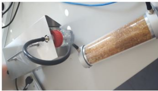
Abb. 2.13. Aufbau der Vergleichsmessung. Die Bilder zeigen die eingezeichneten Abschnitte der oberen Abbildung. Polydisperses Aerosol wird generiert und im SMPS Größenselektiert. Das Monodisperse Aerosol wird anschliessend in den CPCs gezählt.
