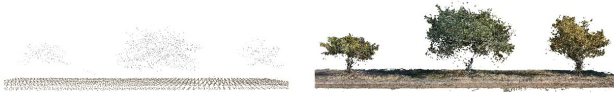
Abbildung 5: Beispiel von Einzelbäumen auf einer Streuobstwiese auf Basis der flugzeuggestützten LiDAR-Punktwolke (links) und auf Basis von Drohnendaten (rechts). LiDAR-Daten ©HVBG
