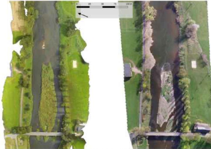
**Bild 4:** Vergleich des Bereichs der sog. „Baggerlöcher“ bei Schmittlotheim vor der Maßnahme (2014 – links) und nach der Maßnahme (2018 - rechts) zum Vergleich an der Straßenbrücke ausgerichtet (C. Dümpelmann/C. Salzmann 2014+2018)
