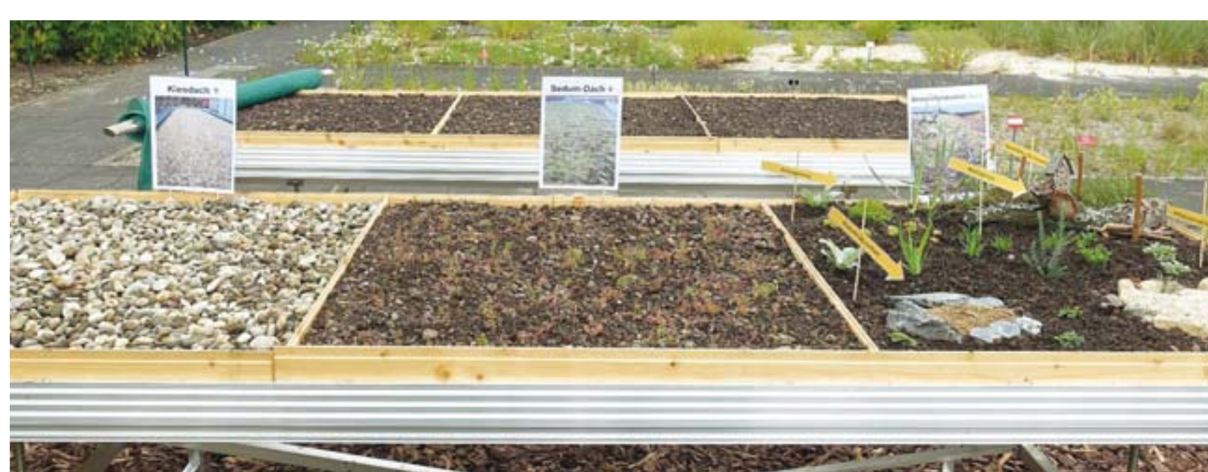
Modellhafter Aufbau verschiedener Dachvarianten im Botanischen Garten, rechts: Biodiversitätsdach.
