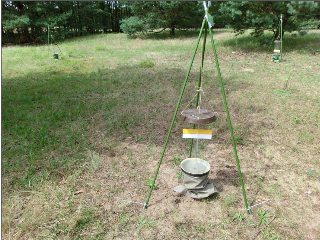
Abb. 6: Viernheimer Heide. Anflugfallen-Ensemble in der Nähe einzeln oder in Gruppen stehender Bäume und Gebüsche.
