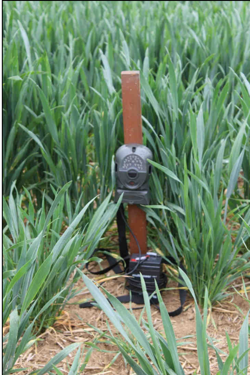
Abb. 37: Die Fotofalle Dörr BolyGuard 5.0 mit externem Akkublock.
