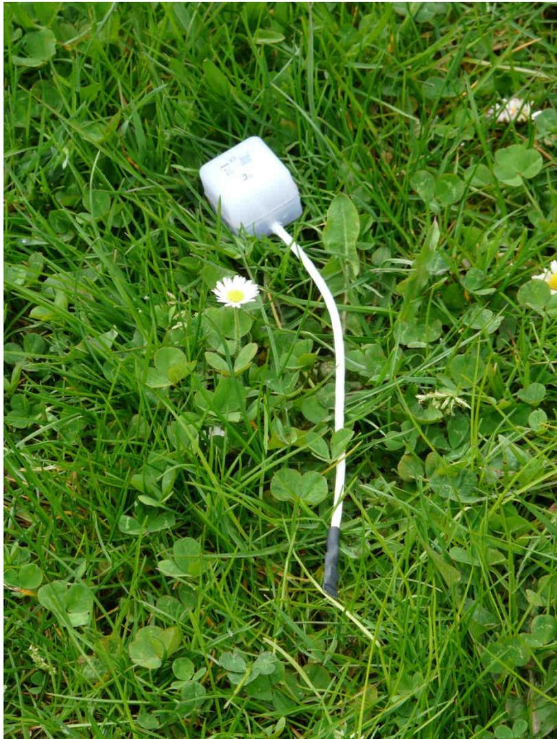
**Abb. 17:** Verwendeter Thermologger.
