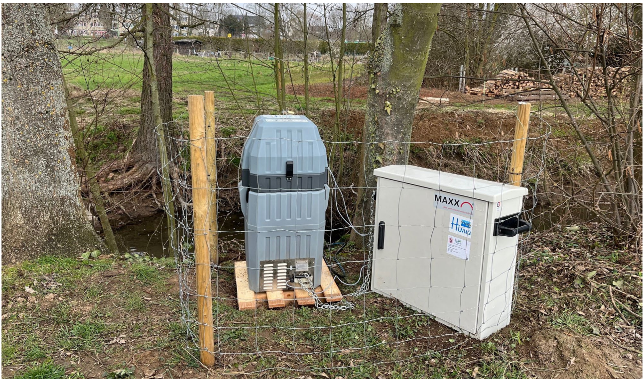
Abb. 6: Foto der Messstelle am Rosbach (RB) mit einem automatischen Probenehmer. © HLNUG
