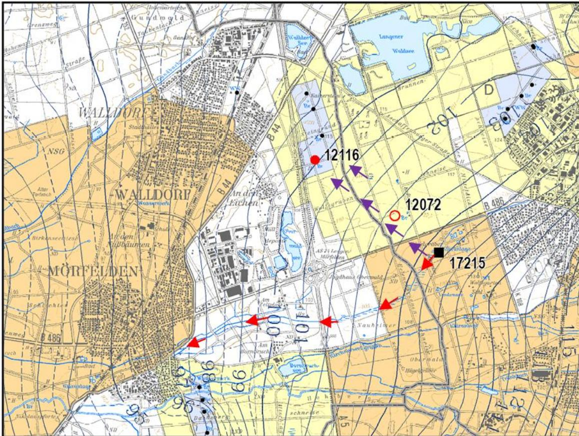
Abb. 21: Darstellung des Gewässernetzes und der Grundwassergleichen im Abstrom der Kläranlage Langen (ID 17215) und der GWM (ID 12072) und des Br. D WW Waldorf (ID 12116) (rote Pfeile: Oberflächenwasserfließrichtung, lila Pfeile: Grundwasserfließrichtung) (Quelle: HLNUG; Ausschnitt aus Karte 1, siehe dort die Messstellenlegende).
