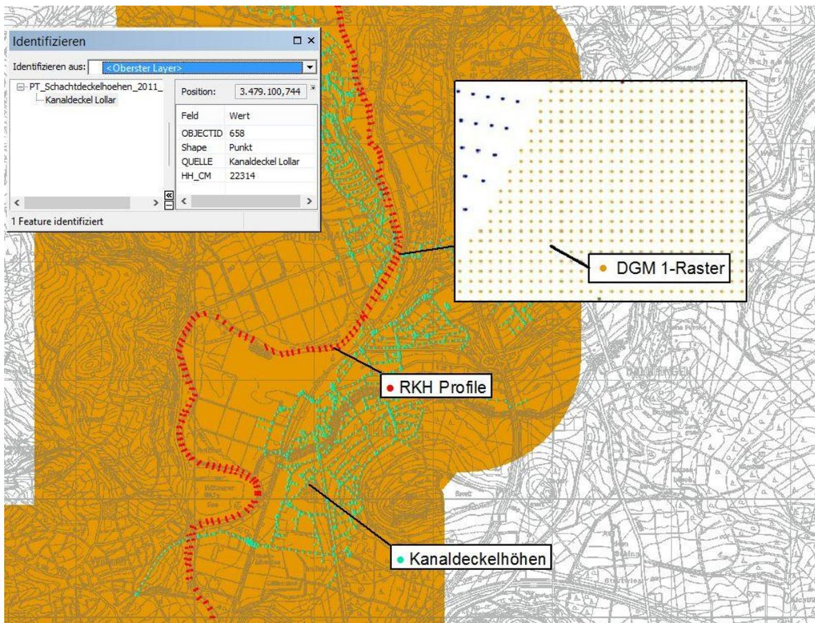
Abb. 4-3: Beispiel für die Datenhaltung und Informationsdichte der neu erstellten DGM
