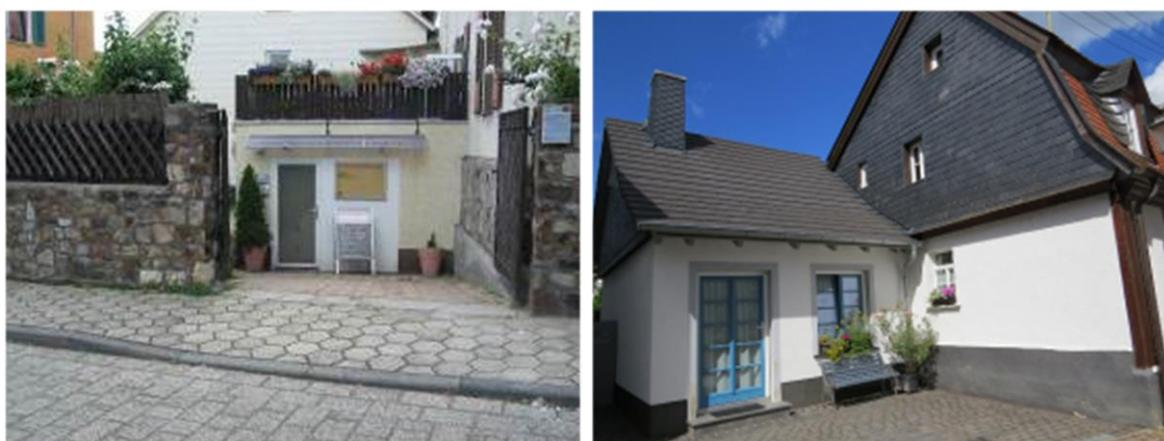
Abb. 6.2: Nicht hochwasserangepasster Ausbau ehemaliger Nebengebäude im Überschwemmungsgebiet (Bildfreigabe durch Hässler-Kiefhaber)
