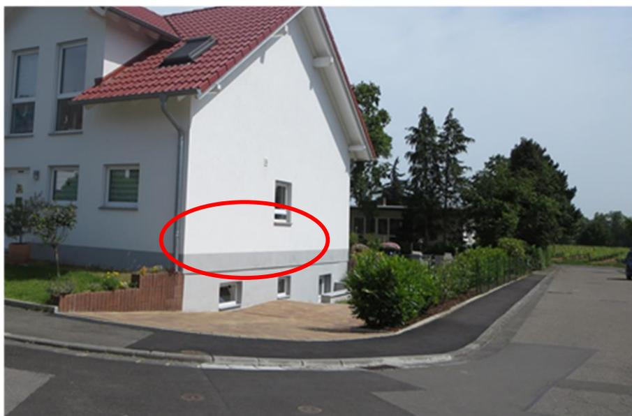
Abb. 6.1: Nicht hochwasserangepasste Bauweise im Risikogebiet (Bildfreigabe durch Hässler-Kiefhaber)
