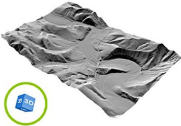
Abbildung 5: Durch Laserscanbefliegung generiertes Modell der Erdoberfläche (HVBG, 2020)
