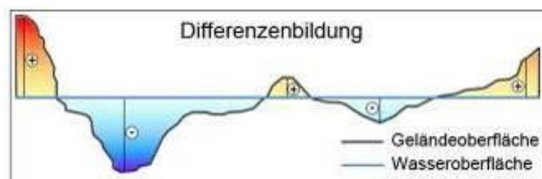
Abb. 4.7: Schematische Darstellung der Erstellung von Wassertiefenrastern durch Differenzenbildung zwischen Wasserspiegelraster und DGM. Blau gefärbte Bereiche entsprechen Überflutungsflächen bzw. Wassertiefen ([34], modifiziert).
