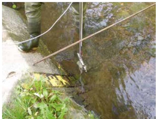
Abb. 16: Durchflussmessung mit Stangenflügel.
