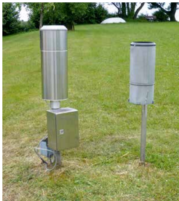
Abb. 7: Niederschlagsmessstelle Freiensteinau mit automatisch aufzeichnendem Messgerät mit Datenfernübertragung (Pluvio) (links) und Hellmann-Messgerät (rechts).
