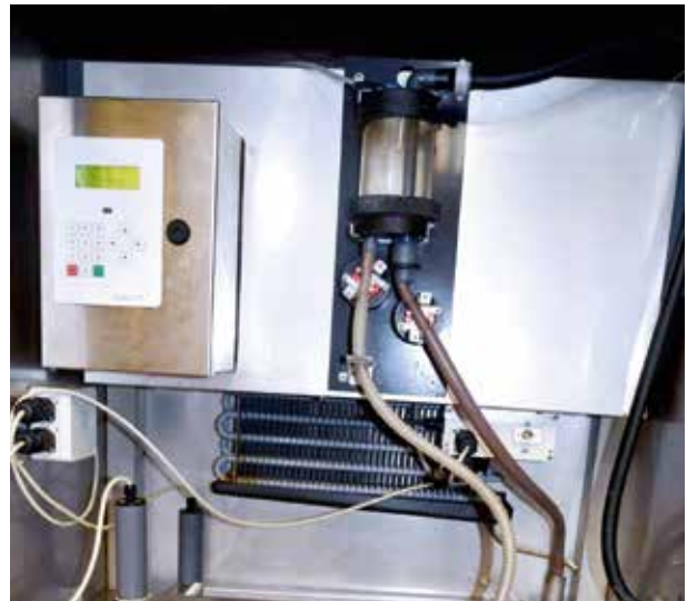
Abb. 40: Automatischer Mischprobenehmer in der Station Bischofsheim.
