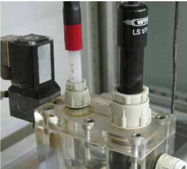
Abb. 39: Kontinuierliche Messung von Wassertemperatur, Sauerstoff, Leitfähigkeit und pH-Wert in der Messstation Hanau.
