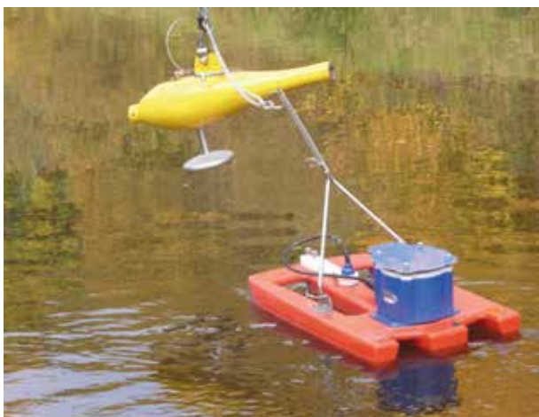
Abb. 15: Durchflussmessung mit mobilem Doppler Ultraschallgerät (ADCP).
