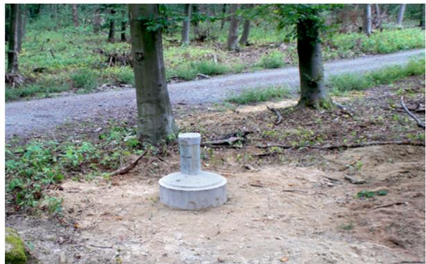
**Abb. 66:** Grundwassermessstelle mit Schutzfundamentsockel.
