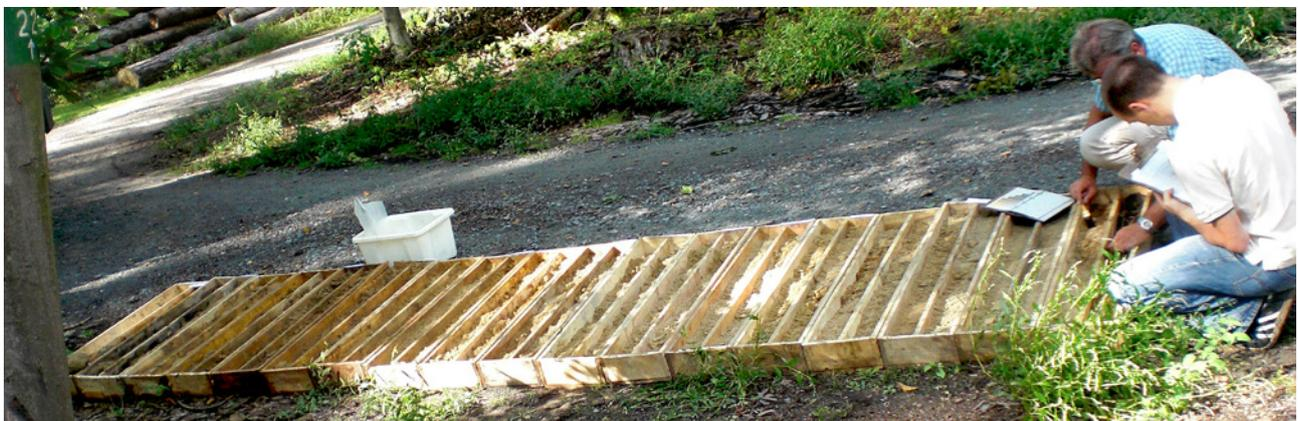
**Abb. 67:** Bohrgutkästen.
