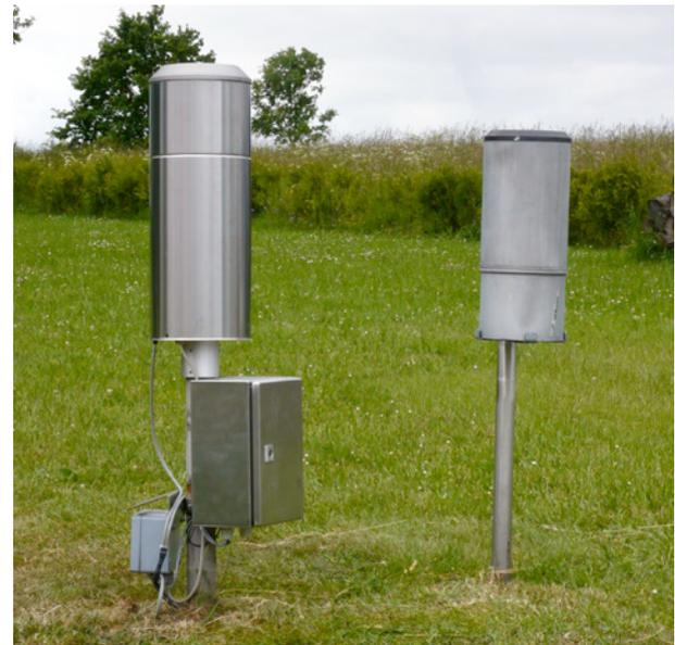
**Abb. 4:** Niederschlagsmessstation Freiensteinau (links automatisch aufzeichnender Pluvio mit Datenfernübertragung, rechts Hellmann-Messgerät zur einfachen täglichen Ablesung).
