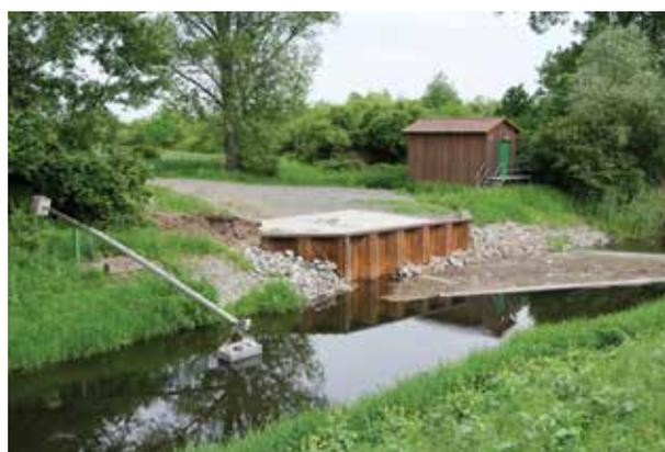
Abb. 29: Messstation und Entnahmeverrichtung am Schwarzbach in Ginsheim.
