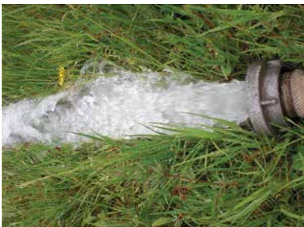
**Abb. 61:** Grundwasserauslauf beim Pumpversuch einer Grundwassermessstelle (15 m<sup>3</sup>/h).
