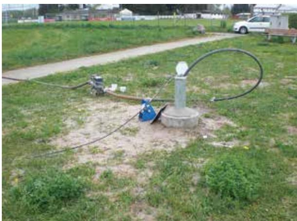
**Abb. 62:** Pumpversuch einer Grundwassermessstelle.
