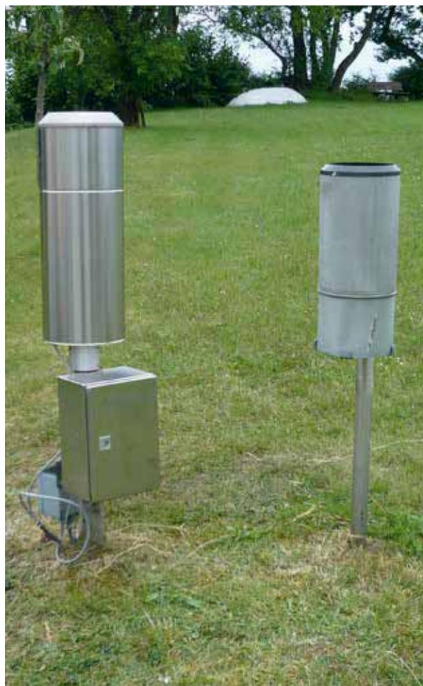
Abb. 7: Niederschlagsmessstelle Freiensteinau (links: Pluvio mit kontinuierlicher Messung in Minutenschritten und Datenfernübertragung, rechts Hellmann-Messgerät, Tagesmessung durch einen Beobachter)
