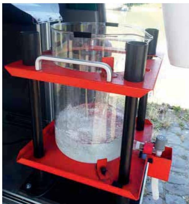
Abb. 44: Homogenisator zur Durchmischung von Proben und Erstellung von Teilproben im Feld
