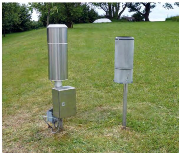
**Abb. 5:** Niederschlagsmessstelle Freiensteinau (links: Pluviometer mit kontinuierlicher Messung in Minutenschritten und Datenfernübertragung, rechts Hellmann-Messgerät, Tagesmessung durch einen Beobachter)
