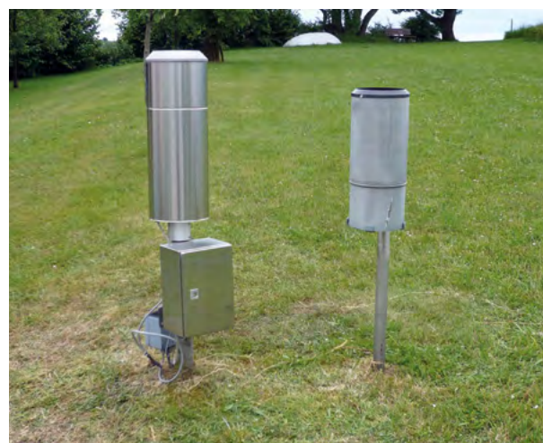
Abb. 7: Niederschlagsmessstelle Freiensteinau (links: Pluviometer mit kontinuierlicher hochauflösender Messung und Datenfernübertragung, rechts Hellmann-Messgerät, Tagesmessung durch einen Beobachter)
