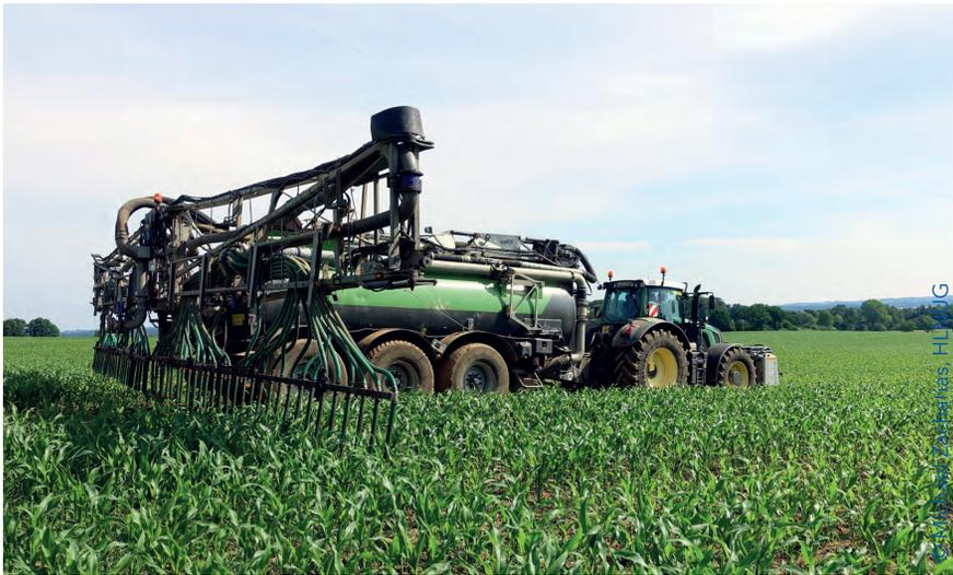
Verlustarme Gülleausbringung mit Schleppschlauch und Ansäuerungstechnik
