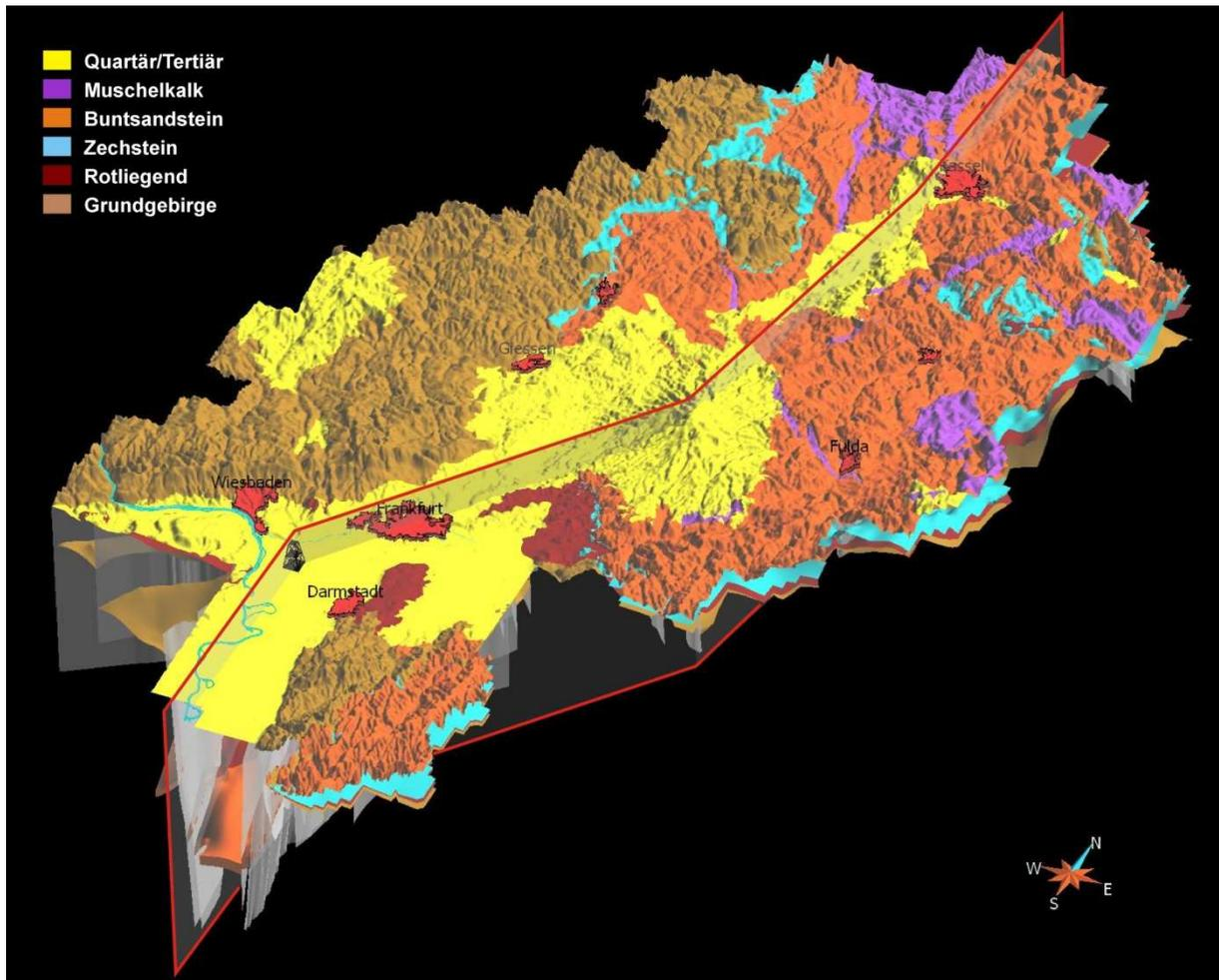
Geologisches 3D-Modell von Hessen (10 fach überhöht)(Arndt et al. 2011). Blick von Südosten in den nördlichen Oberrheingraben auf die für die eindimensionale Potenzialbetrachtung konstruierte virtuelle Bohrung (Bohransatzpunkt als schwarzer Bohrturm) und den für die zweidimensionale Betrachtung konstruierten geologisch/geothermischen Schnitt (graue transparente Fläche mit rotem Rand)
